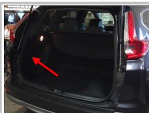
3.2 并把 ECU 固定在原车钣金上，3M 胶贴在左侧装饰板内部固定，防止松动；
