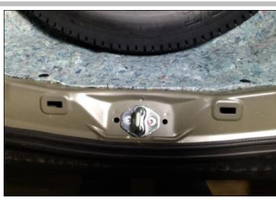
4.2 拆下原车锁扣组；
