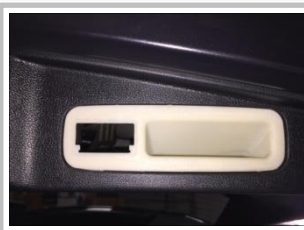
3.6 把开关按钮装在底座上，再安装在原车上，用螺栓固定好；
