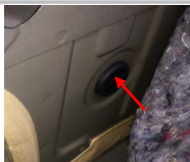
1.11 电机线束穿过此胶塞孔，布置好线束后，把胶塞封口；
