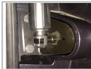
1.4 安装右下支架 把我司配右下支架根据支架箭头提示朝向还原安装，
