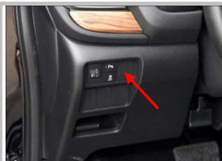
3.9 中控开关安装在原车中控台位置
