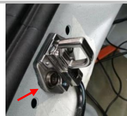
4.3 用异型螺栓安装 Mini 门锁，门锁底部增加 3mm 垫板；
