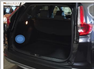
2.1 拆下左侧尾箱内部装饰件，蜂鸣器、ECU 安装于内侧；
