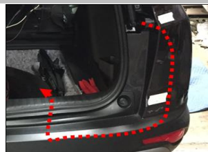
1.9 右撑杆电机线如图示意走线，注意负极线也同样布线；
