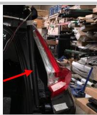
1.6 把我司配的右撑杆装在支架及万向头上，如图已安装好；
