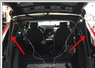
1.7 左撑杆对称安装即可；提示：用同样方法安装另一边撑杆、电机线束；
