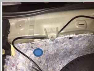
1.10 如图示意拆下后踏盖，掀开挡板看到原车胶塞孔；
