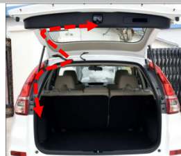
2.3 布线：信号线、开关需延伸到上门锁位置
